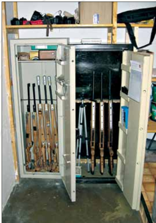
Våpenskap skal boltes fast iht. monteringsanvisningen.
