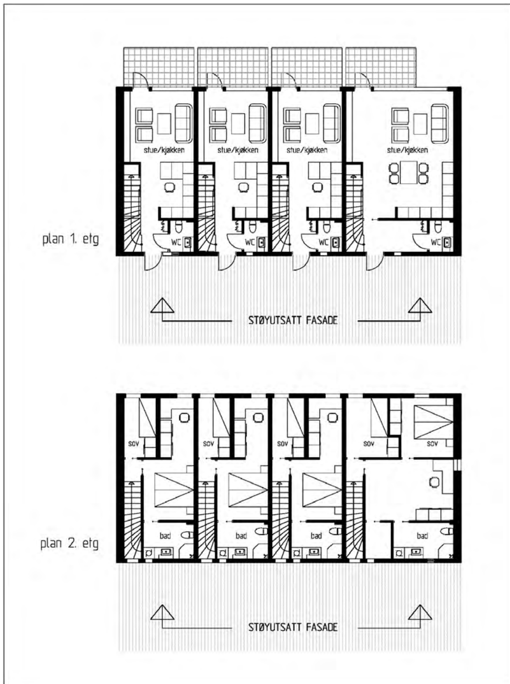
Figur 24. Eksempel på aktuell planløsning i rekkehus med stille side. Vist med leiligheter i to ulike bredder. Illustrasjon: Asplan Viak Bergen AS.
