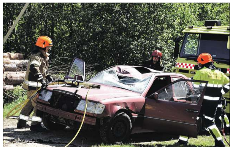
Frigjering: Slik såg bilen ut etter at brannmannskapet hadde gjort sitt med stålsaks, klipper, slegge og kjettingar. No var det berre å få ut den skadde som under arbeidet var dekt av teppe for å hindre glasskader.
